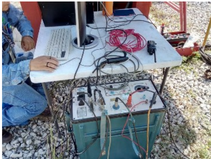
Figura 3.3 Equipo de prueba TDR 9000
