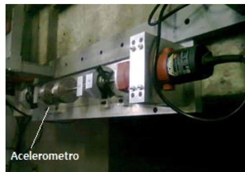
Figura 18.- Colocación del acelerómetro sobre el nodo a analizar.
