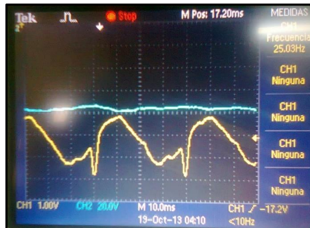
Figura 78.- señales medidas en el osciloscopio. Azul, Señal de la vibración después del balaceo. Amarilla, frecuencia de giro 25 Hz
