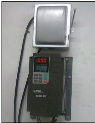
Figura 133.- Variador de frecuencias 10 Hz.
