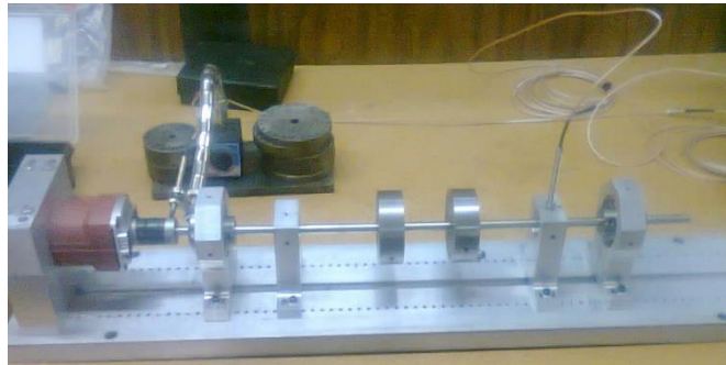
Figura 71.-Rotor banco de pruebas, instrumentado para el balanceo.
