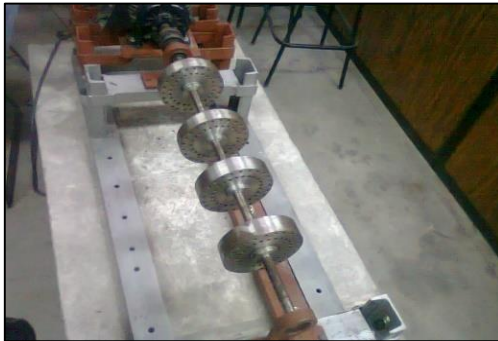
Figura 107.- Desalineamiento visual y desacople del rotor.
