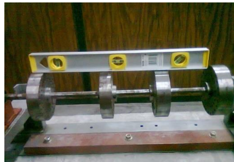
Figura 114.-Identificacion del desnivel en el eje.
