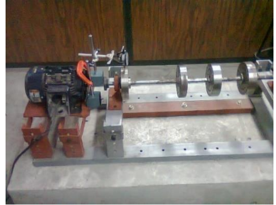
Figura 122.-Fijacion del rotor y corrida de verificación.
