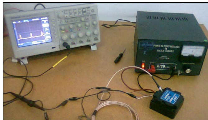
Figura 135.-Equipo analizador y señal recibida de la frecuencia de giro
