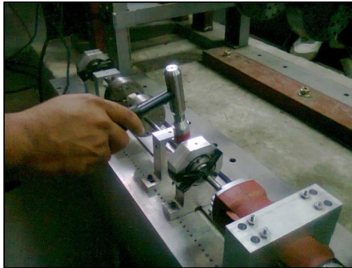
Figura 59.- Golpes del martillo de impacto en el nodo 7.
