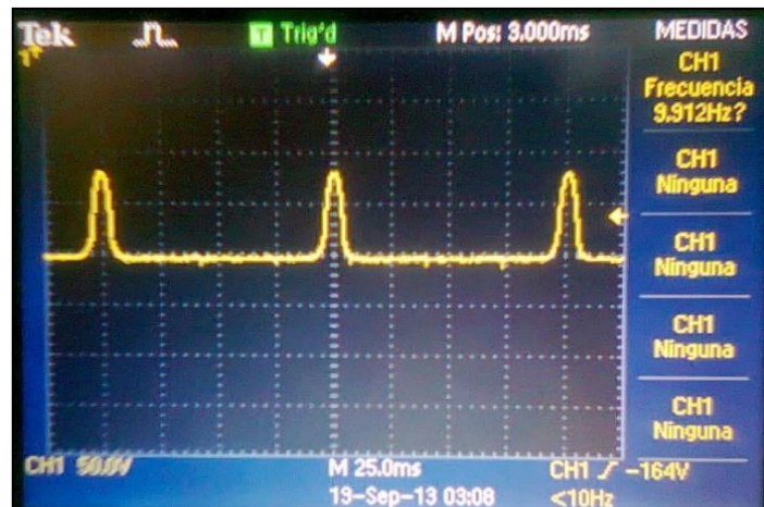
Figura 136.-Señal en el osciloscopio, frecuencia de giro. Prueba 1.
