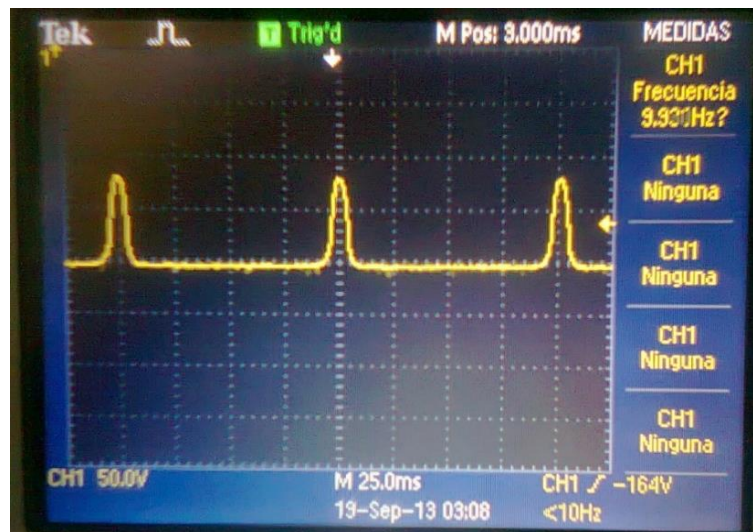
Figura 141.-Señal en el osciloscopio, frecuencia de giro. Prueba 2.
