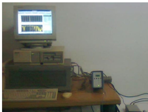
Figura 151.-Analizador de frecuencias. Prueba nodo 3.
