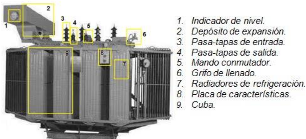
Elementos que componen el transformador sumergido en aceite con depósito de expansión.
