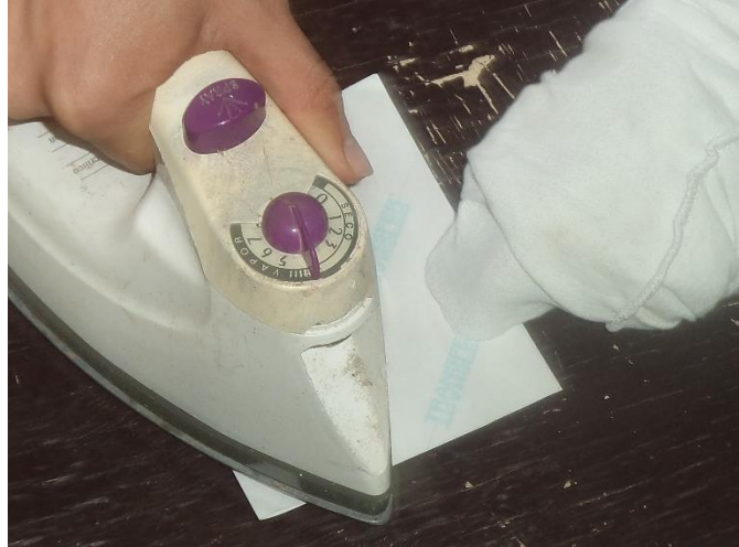
Imagen 76 Planchado de la placa.
