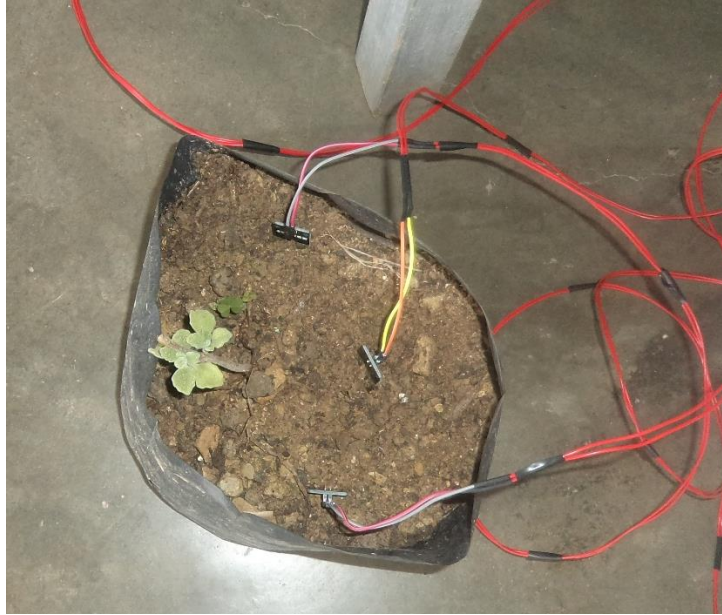
Imagen 85 Sondas de humedad.
