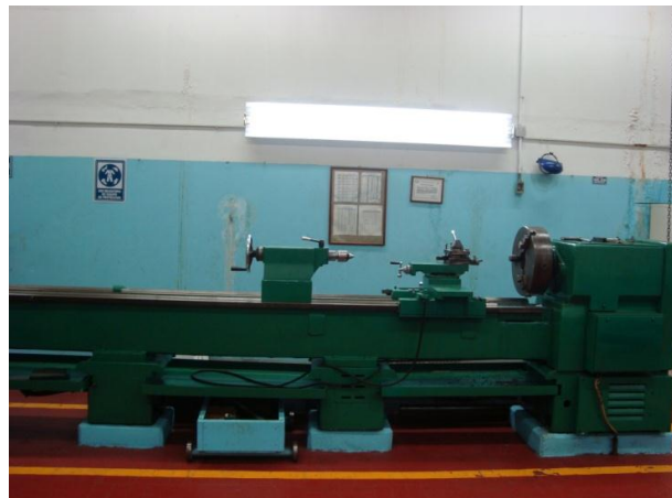
Torno horizontal de 6 m bancada
