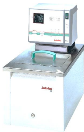
Figura 62. Cámara de baño térmico de pruebas de calibración
