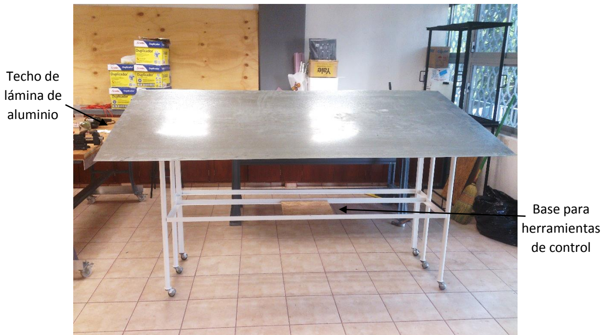
Figura 77. Techo de aluminio para la base de los equipos de aire acondicionado
