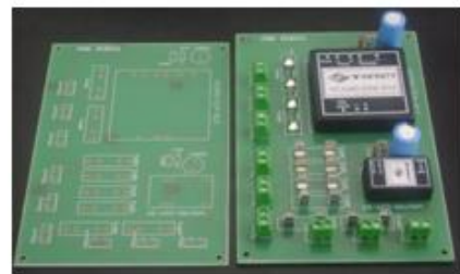
Figura 4.6.- Tarjeta de Potencia con Salida de 5V y 12V.
