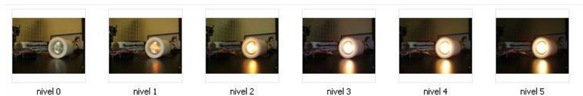
Figura 4.13 Diferentes niveles de intensidad luminosa de las lámparas submarinas.
