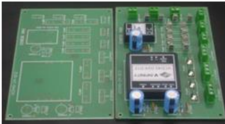
Figura 4.5.- Tarjeta de Potencia con Salida de 5V y \pm 12V .
