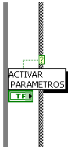
Figura 3.5 ciclo case condicionado por el botón activar parámetros.
