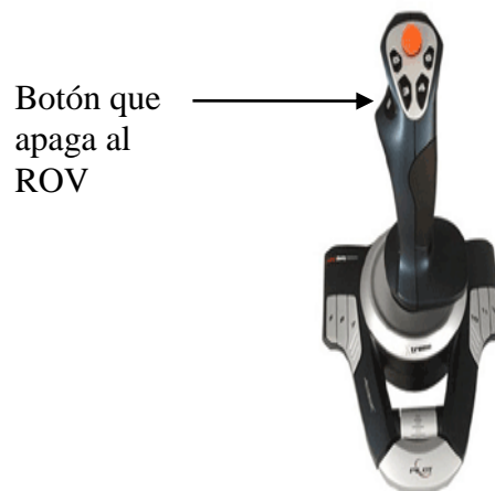
Figura 3.37.-VI Jostick que controla el apagado del ROV.
