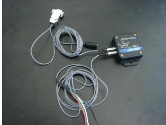
Figura 3.25 Inclinómetro y sus cables de conexión.
