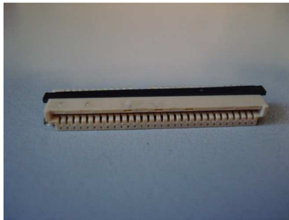
Figura 2-3. Conector extraído para su reutilización en nuestra nueva conexión.
