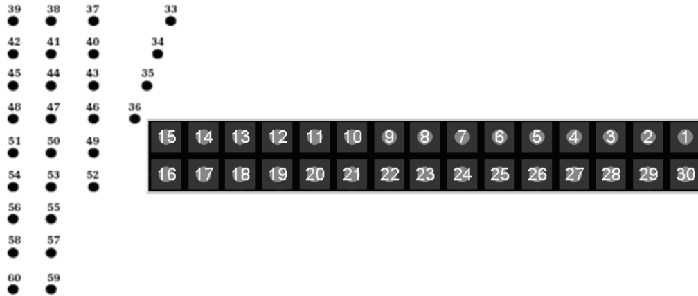
Figura 2-8. Conexión de pines de cobre, del no. 33 al 60 del nuestro cartucho c6614n (#20) HP y nuevo hardware realizado para su control (tira de pines machos).
