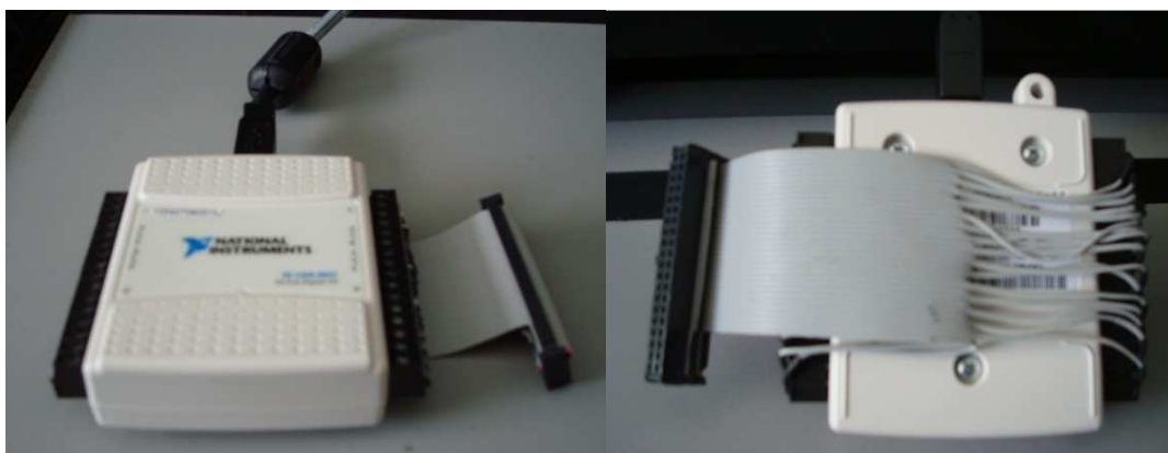
Figura 5-2. Izquierda. Vista frontal de la DAQ NI USB-6501 y el conector de cable plano. Derecha. Vista posterior de la conexión realizada.
