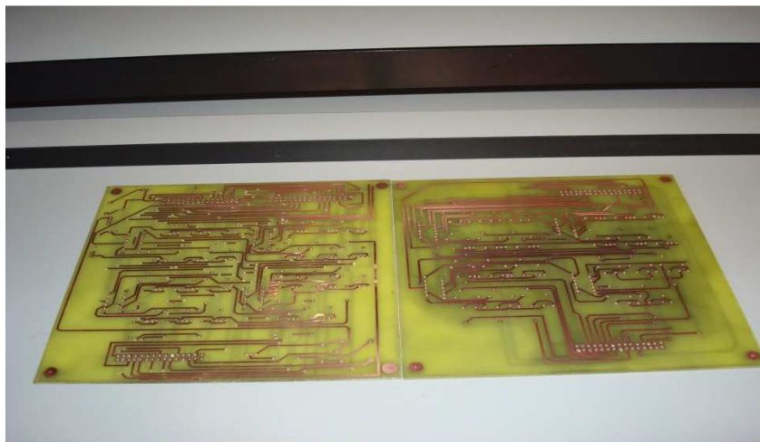
Figura 4-5. Parte del circuito de control del sistema de inyección de micropartículas.
