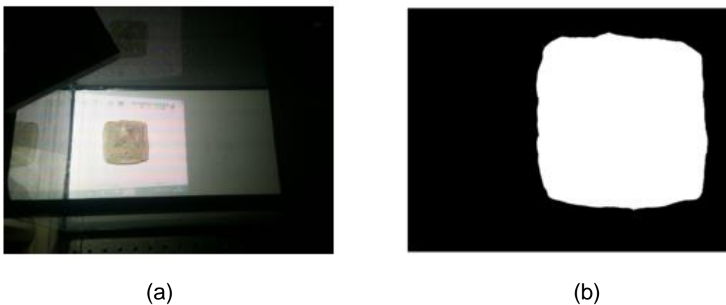
Figura 4.16 a) Fuente de iluminación para la eliminación de sobras para la obtención de la máscara binaria (b) Mascara binaria.
