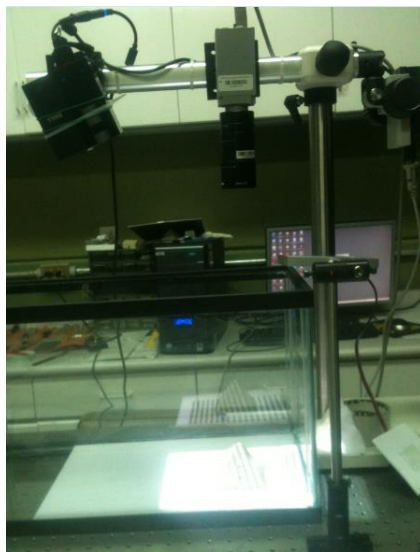
Figura 4.1 Arreglo experimental del sistema de proyección de franjas para la reconstrucción de una pirámide, en un medio acuoso sin turbiar.
