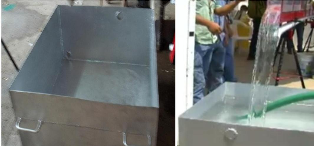
Figura 5.1 Tanque volumetrico con toma y recirculacion del caudal al sistema
