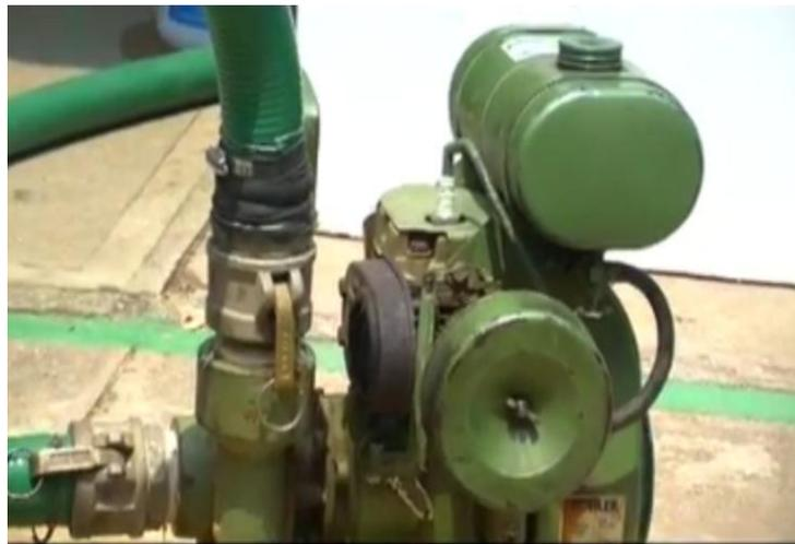
Figura 5.2 Bomba de gasolina de tres caballos de fuerza con salida de dos pulgadas
