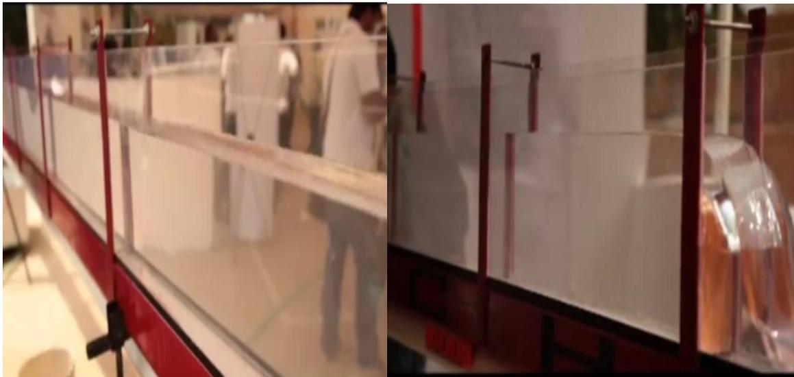
Figura 5.4 Puentes superiores metalicos para rigidizar el canal
