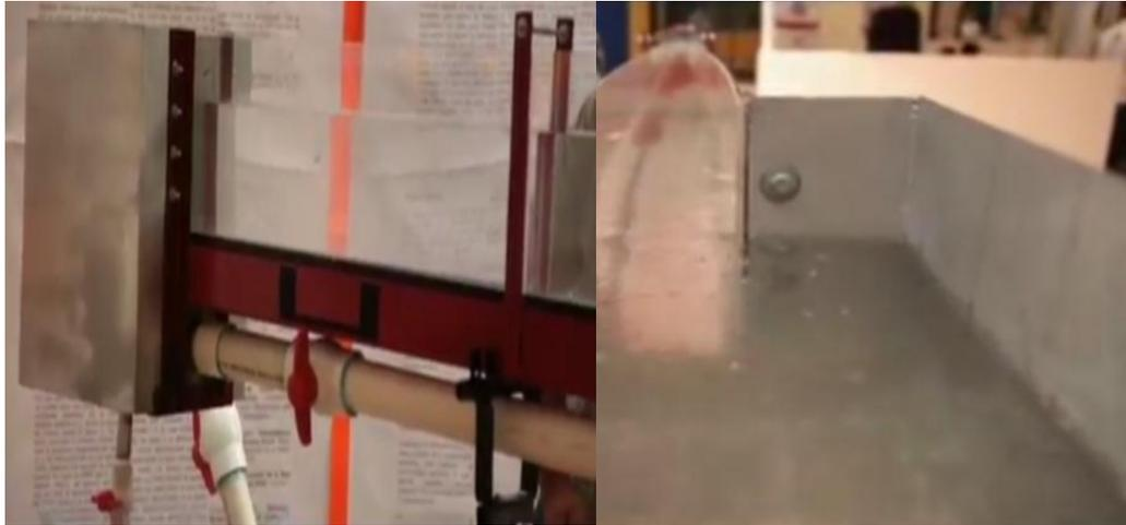
Figura 5.3 Tanque disipador de energía del agua del sistema
