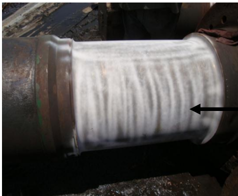
Figura No. 4.27 prueba de líquido penetrante en el eje
