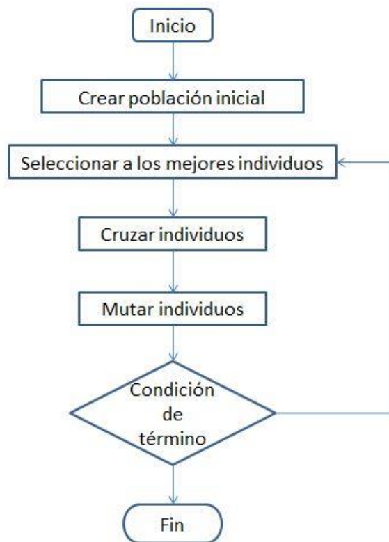
Figura 3. 10 Diagrama a bloques de un Algoritmo Genético.
