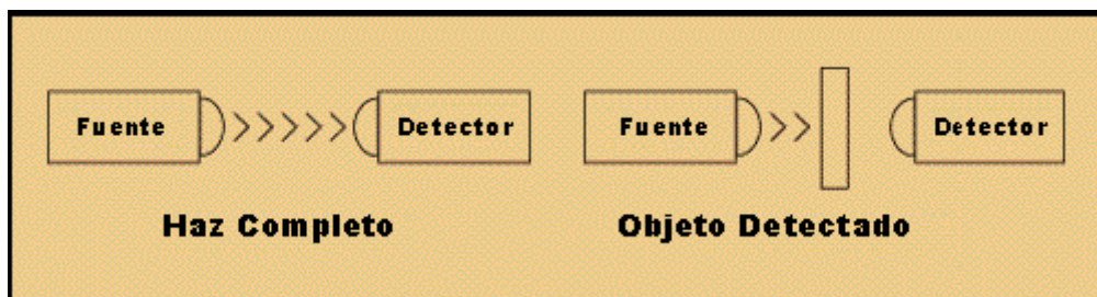
FIGURA 1. SENSOR FOTOELÉCTRICO DE HAZ DIRECTO
