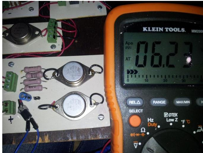
Foto 5. Voltaje máximo de la fuente de corriente.
