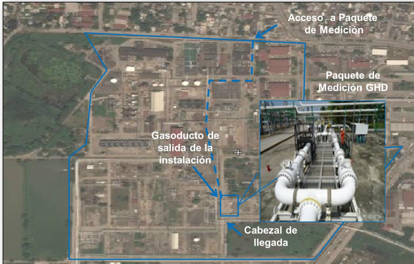
Figura C.1 Diagrama de planta ubicando el sistema de medición gas húmedo dulce en el Complejo Procesador de Gas Poza Rica
