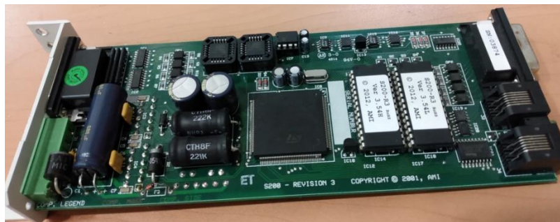
Fig. 3.1 Controlador Lac-25 en su parte interna
