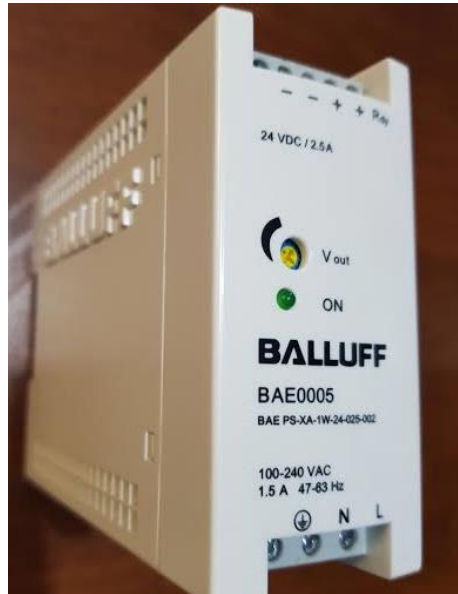
Fig. 2.6 Fuente de voltaje de la marca BALLUFF
