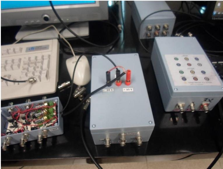
Fig. 4.14 realizamos una separación para tomar de la fuente varias salidas y alimentar otros circuitos.
