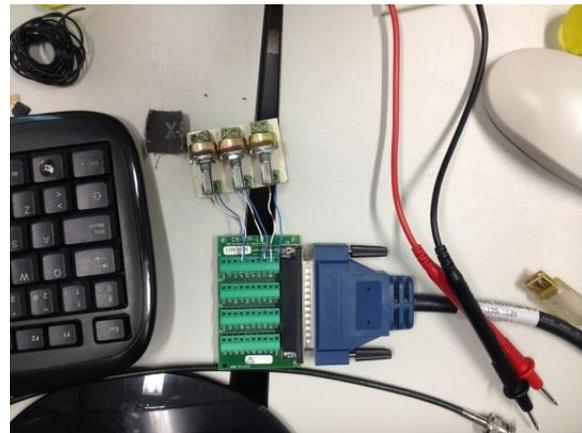
Fig.4.1 El block terminal leería las 3 señales
