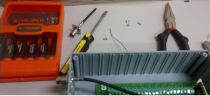
Fig.4.3 Cambio de terminal BNC debido a ruptura
