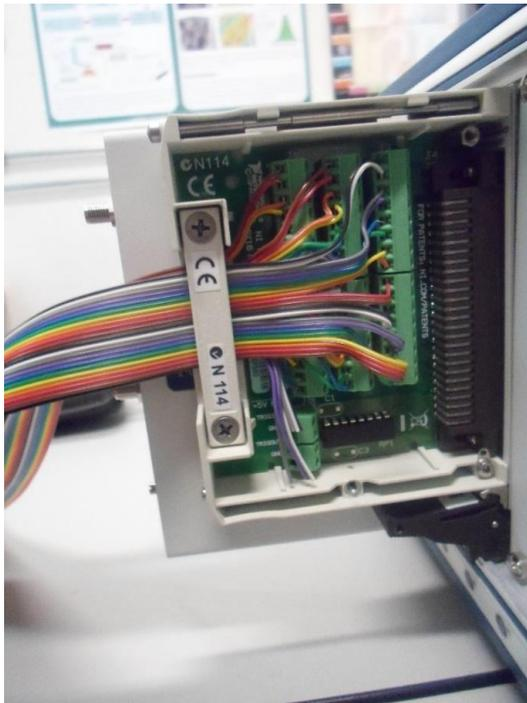
Fig.4.27 cable plano de colores para identificar cada terminal.
