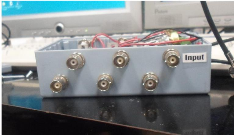
Fig. 4.17 Entradas inferiores multiplicadoras.
