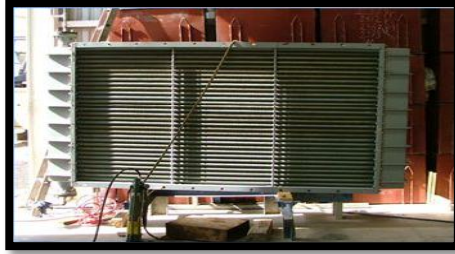
Fig.A19 Intercambiador de calor.
