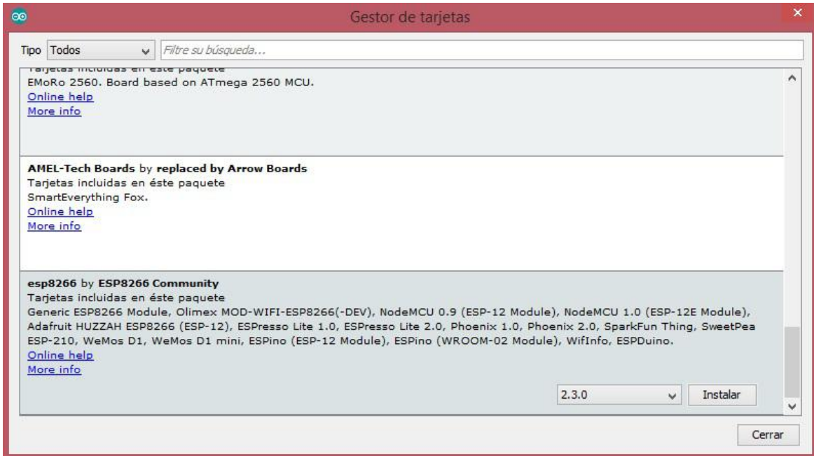
Imagen 37. ESP8266 en Arduino paso 2 (Fuente: Propia)
