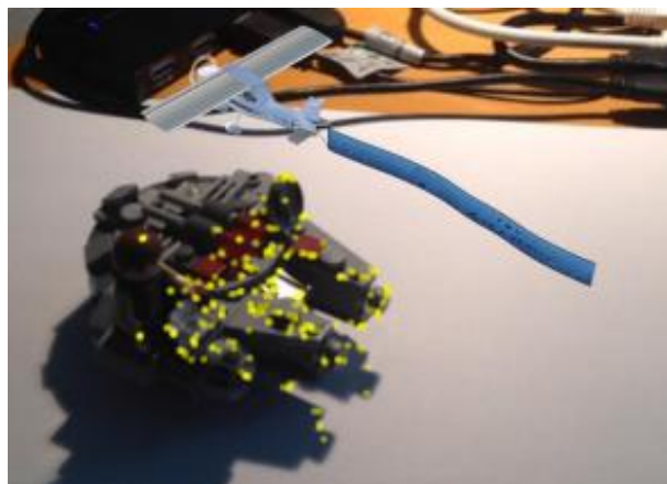
Imagen 12. Objeto como marcador para RA (Fuente: MODELO DE REALIDAD AUMENTADA Y NAVEGACIÓN PEATONAL (Joo, 2011))
