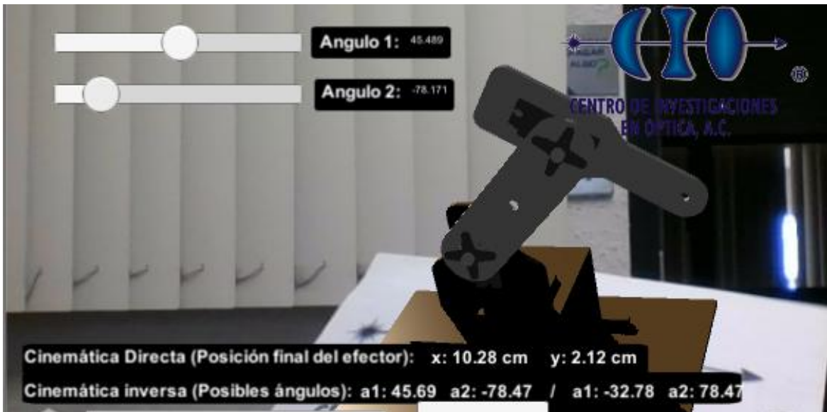
Imagen 61. Movimiento de los brazos y cálculos de cinemática (Fuente: Propia)
