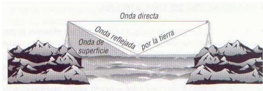
Figura 2.11: Componentes de las ondas terrestres.
