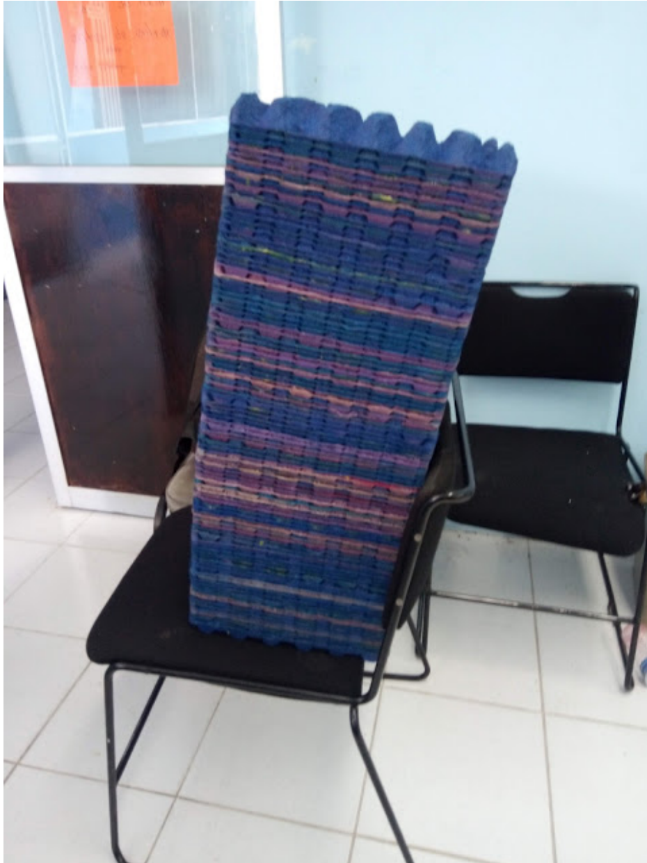
Figura 3.44: Casilleros de cartón como material absorbente.
