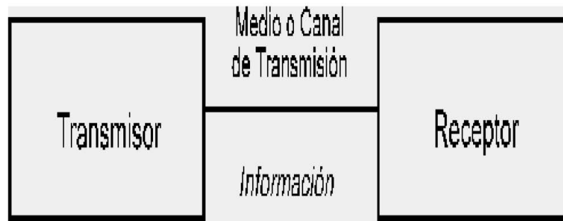
Figura 2.1: Modelo básico de un sistema de comunicaciones.
