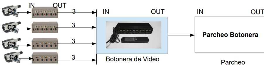
Figura 3.59: Conexion de Cámaras a Distribuidor de video. Salida a botonera de video.
