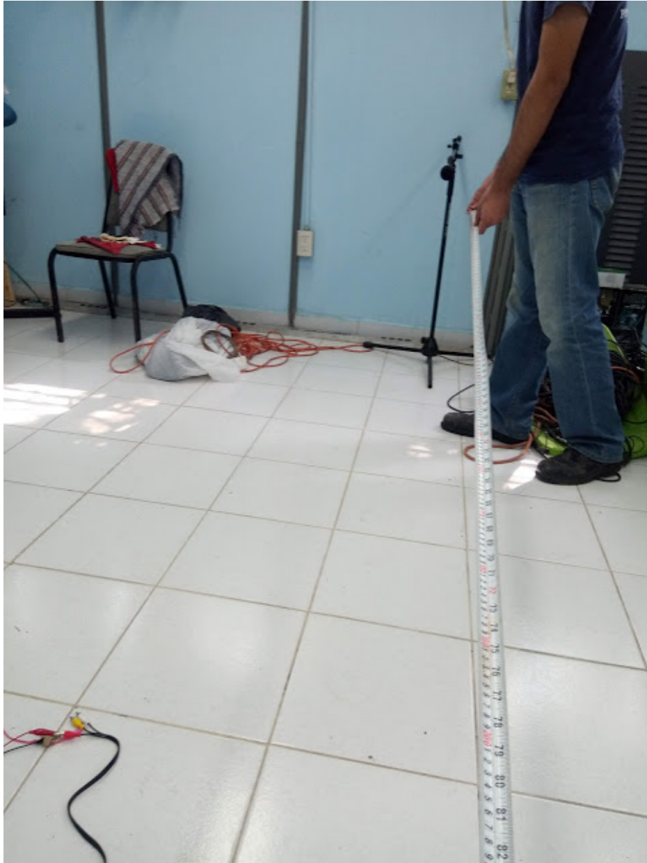
Figura 3.32: Distancia de 2.5m entre bocina y micrófono.
