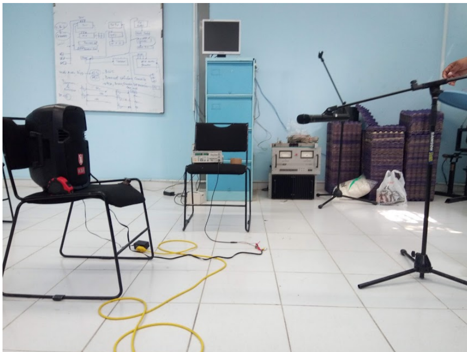
Figura 3.31: Distancia de 1m entre bocina y micrófono.
