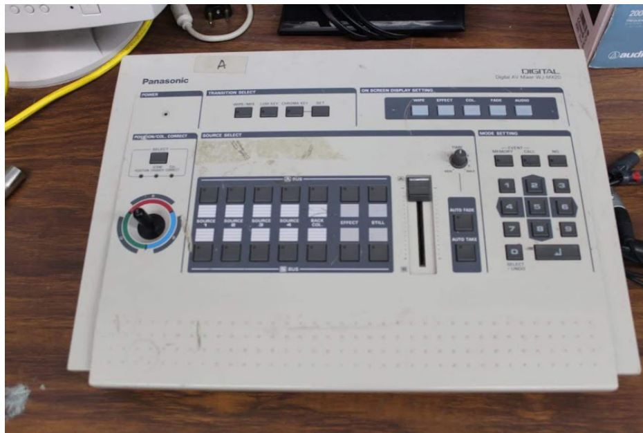
Figura 2.26: Mezclador de video o switcher Mixer Panasonic WJ-MX20.
