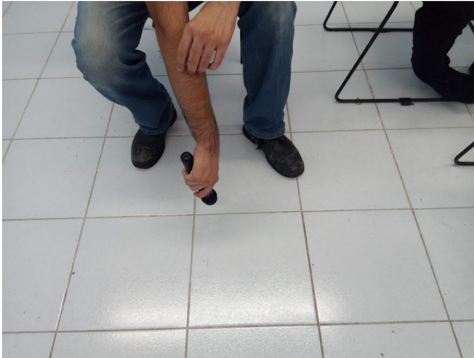
Figura 3.35: Micrófono registrando en dirección al piso.
