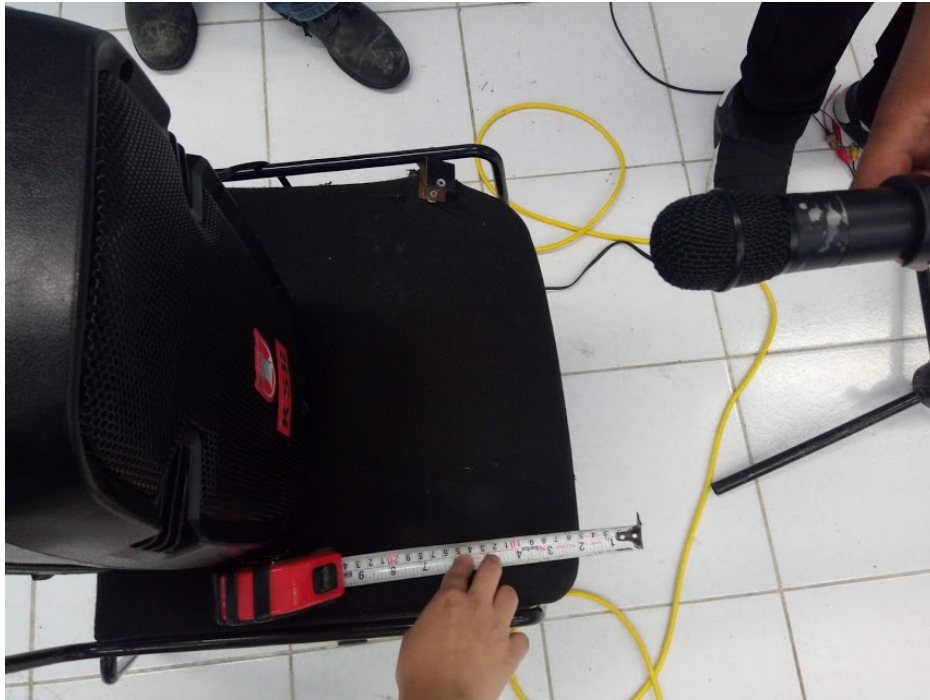
Figura 3.30: Distancia de 20cm entre bocina y micrófono.
