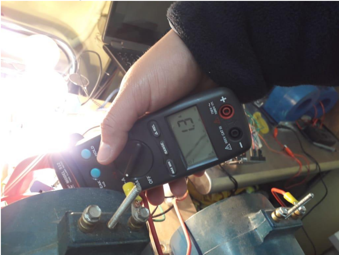
Figura 3.23 Medición con amperímetro para ver si la lectura es correcta.
