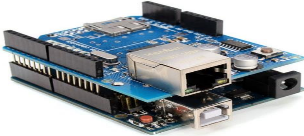
Figura 2.7 Conexión del Módulo Shield Ethernet a la placa Arduino.
