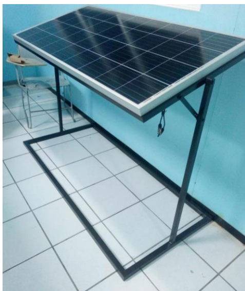
Figura 3.3 Montaje del Panel Fotovoltaico a la base diseñada
