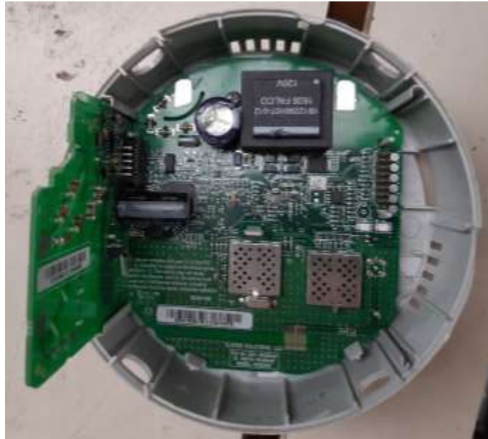
Fig. IX, Parte interna del Medidor
