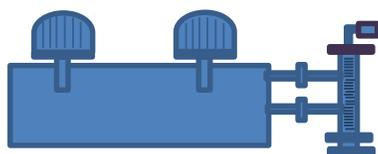
Detector de nivel para el depósito de aceite de regulación. Instalado junto a la bomba, con mirilla graduada y rodillos magnéticos.
