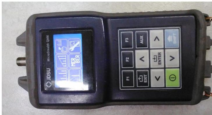
Fig. 53 - Algunas de las veces se hizo la medición de la señal con este equipo llamado JDSU.
