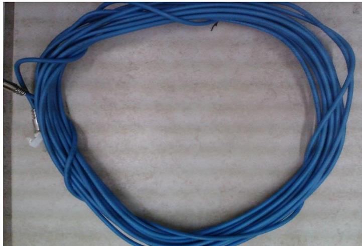
Fig. 50 - Cable mini coaxial para los down stream via placa metalica – transmisores.
