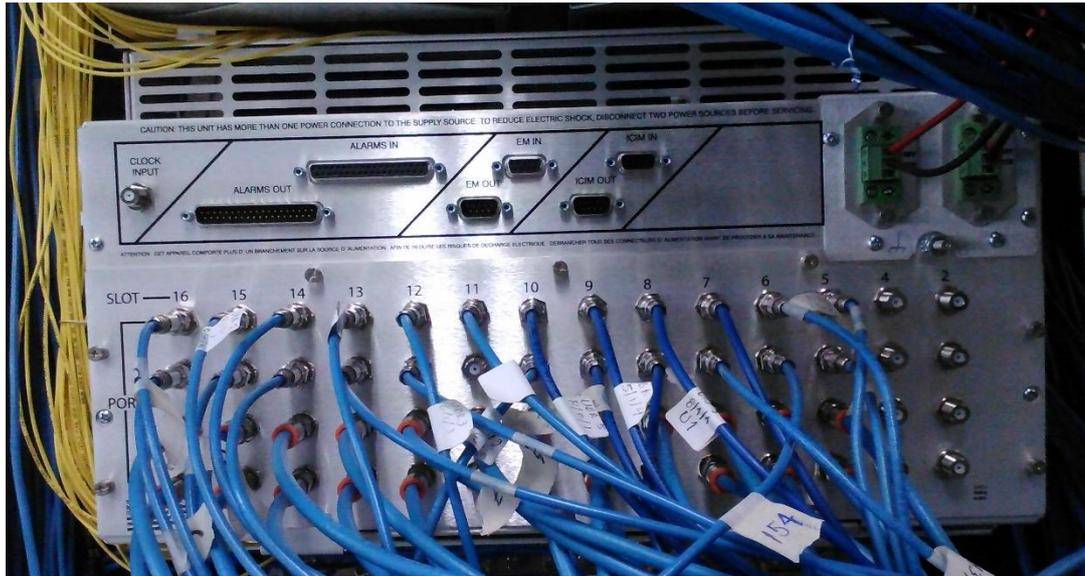
Fig. 23 - Las primeras dos posiciones no son usadas en los puertos traseros de este chasis porque allí están las fuentes de alimentación, el energizado de la misma se hace en las culcas superiores verdes observada en la imagen.
