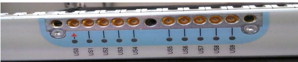
Fig. 47 - Puertos donde se inserta la peineta (up stream) del cable del UBR.
