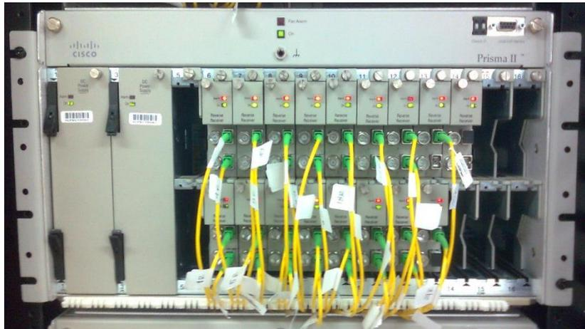
Fig. 30 - Chasis de receptores parte frontal.
