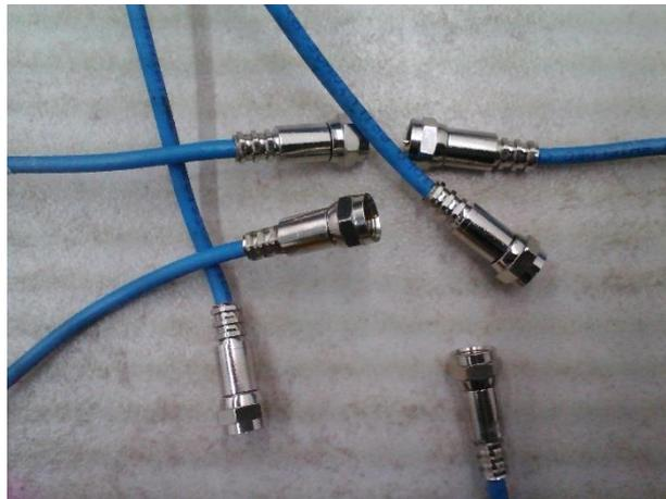
Fig. 22 - Cables mini coaxiales punchados con su respectivo conector, estos conectores se usan para el cableado de down stream y up stream (servicios de internet y telefonía).
