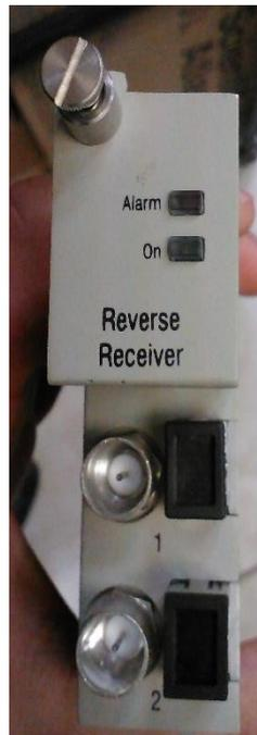
Fig. 24 – Receptor Óptico.
