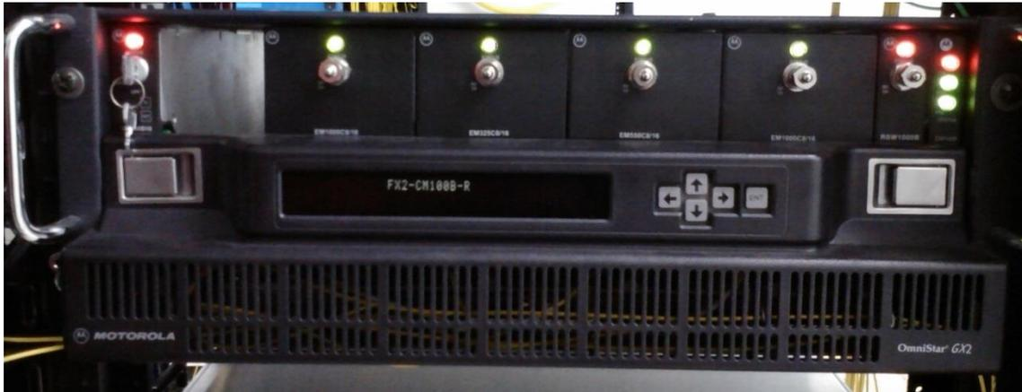
Fig. 10 - Receptor donde por medio de fibras ópticas llegan a él canales con una señal 50 % análoga y 50 % digital.
