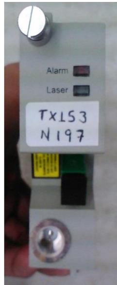
Fig. 14 – Transmisor óptico.
