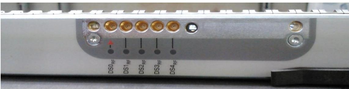
Fig. 48 - Puertos donde se inserta la peineta (down stream) del cable del UBR.
