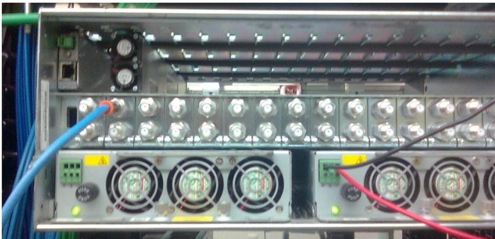
Fig. 35 - Receptor Motorola parte de atrás.
