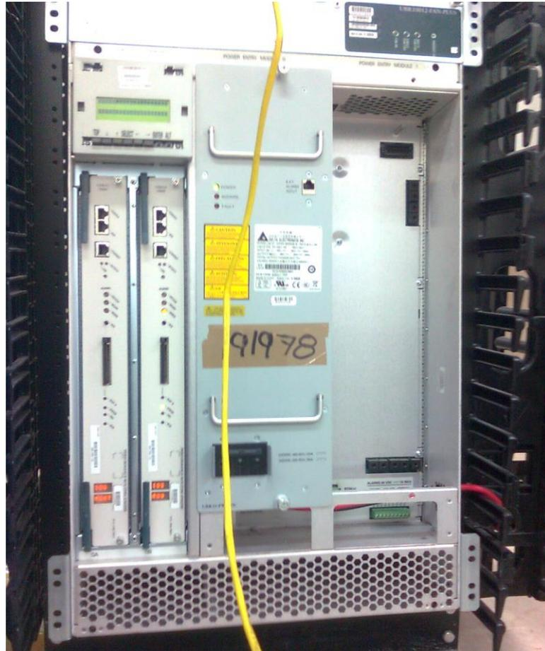
Fig. 17 - UBR aún no configurado completamente y con una sola fuente de alimentación, esta es la parte frontal.
