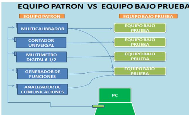
Para lograr esto, se debe contar con una tarjeta de comunicación, la tarjeta se llama ni EXPRESS CARD-GPIB (IEEE-488.2), esta tarjeta utiliza un software de NATIONAL INSTRUMENT llamado MEASUREMENT & AUTOMATATION, ya teniendo el software instalado permite el reconocimiento de los equipos patrones.
