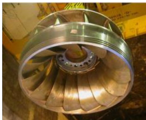
Imagen 2.5. Fotografía de un rodete de una turbina Francis.
