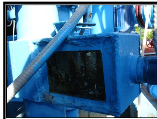
Img. 3.22 Sensor de nivel (flotador dentro de cubo con mirilla)
