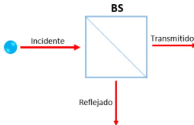
Figura 10: Diagrama de interacción de un fotón con un divisor de haz.
