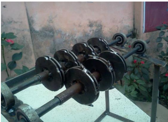
Fig. 17 Detalle de muescas y puntas en los discos del compactador.
