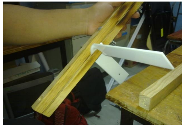
Fig. 22 Brazo del recolector hecho de una misma pieza, se detalla los 90^\circ de giro.
