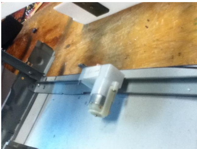
Fig. 27 Motorreductor de 5V utilizado para levantar la escobilla
