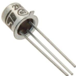
Fig. 8 Encapsulado metalico del transistor 2N2222
