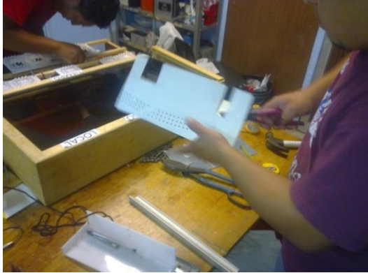
Fig. 20 Elaboración de las tapas laterales del depósito.
