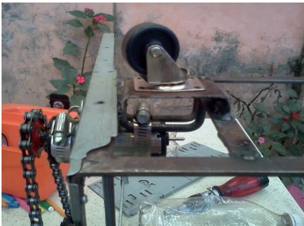
Fig. 19 Detalle de la llanta de giro libre y la base sobre la cual está colocada.
