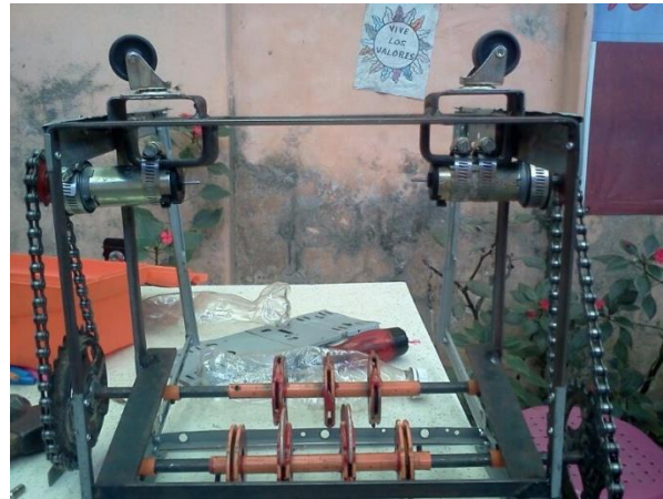
Fig. 18 Sistema de cadenas y coronas que proporciona la fuerza de compactación.
