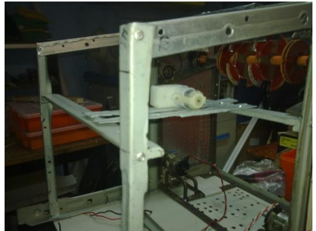
Fig. 23 Motorreductores de 5V utilizado para levantar
