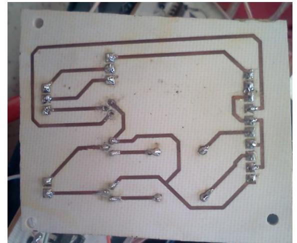
Fig. 37 Fotografía de la parte trasera de la placa de potencia del compactador.
