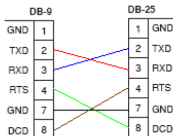
Figura 1.15. Configuración interface para repetidor
