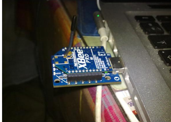
Figura 43.- Radio transmisor XBEE Serie 1 Pro y tarjeta exploradora / programadora para XBEE dongle.
