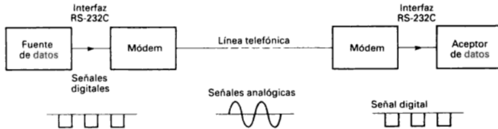
Figura 14.- Transmisión de datos utilizando módems.
