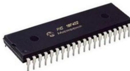
Figura 2.2: Microcontrolador PIC18F452
