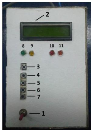
Figura 3: Detector de CO y CO<sub>2</sub>
