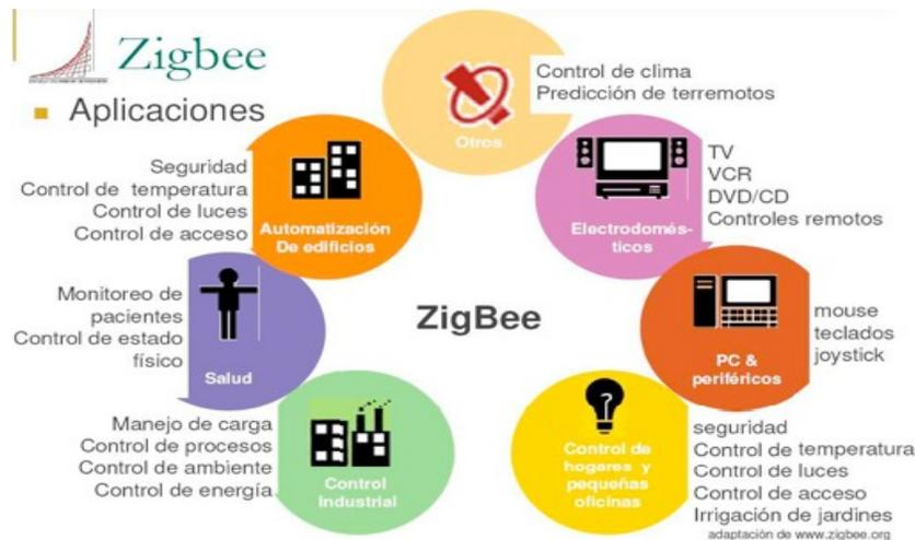
Figura 7.10 Aplicaciones del protocolo Zigbee
