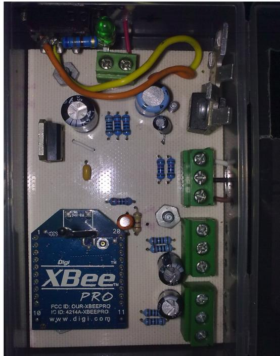
Figura 8.10 Tarjeta de Adquisición de datos con XBee
