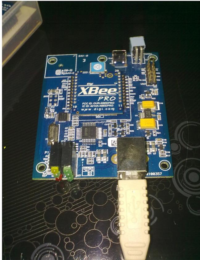
Figura 8.12 Receptor y Transmisor por USB al Ordenador
