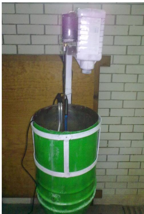
Figura 8.6 Prototipo del reactor de Biodiesel con los sensores PT100 y WQ201
