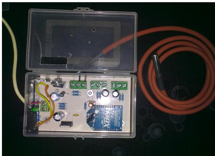
Figura 8.9 Sensores conectados a la tarjeta de Adquisición de Datos
