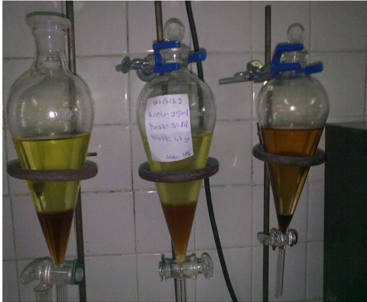
Figura 8.4 Metanol, NaOH y Aceite preparándose para la mezcla
