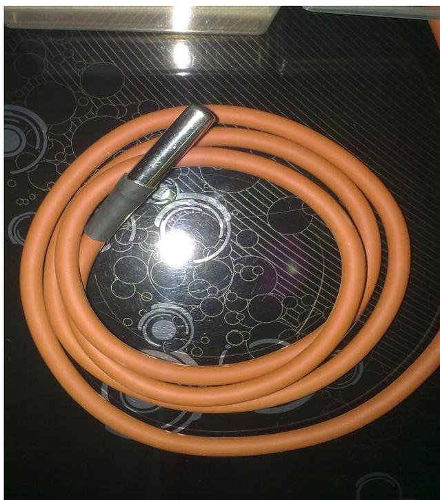
Figura 8.7 Sensor de Temperatura PT100
