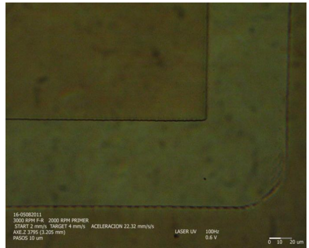
Figura 39. Patrón grabado a 0.6 Volts, pasos de 10 \mu\text{m} , obteniendo un ancho de línea de 95 \mu\text{m} . La potencia del laser utilizada fue ideal para los tiempos de exposición y revelado establecidos
