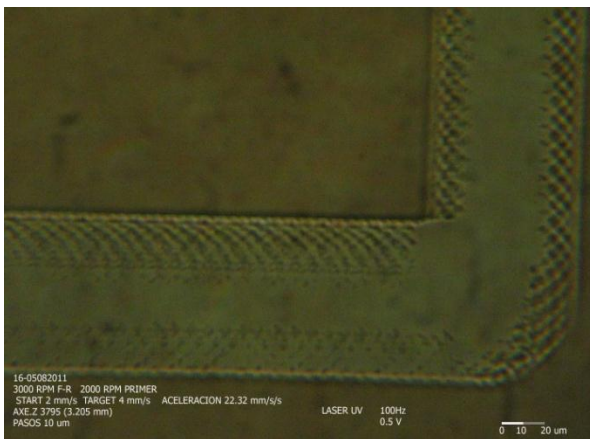
Figura 40. Patrón grabado a 0.5 Volts, a pasos de 10 \mu\text{m} , Ancho de línea logrado de 90 \mu\text{m} . La potencia fue insuficiente para el tiempo de exposición utilizado o se requería mayor tiempo de revelado.
