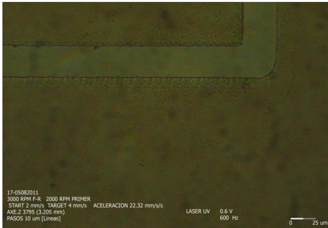
Figura 46. Patrón grabado a 600 Hz, con pasos de 10 µm, logrando un ancho de línea de 32 µm. esta prueba fue realizada con la intención de reproducir resultados anteriores.
