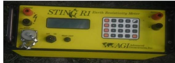
Figura 4.1.3 Resistivímetro comercial sting R1
