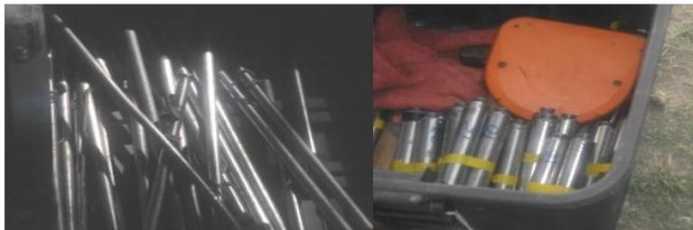
Figura 4.1.4 electrodos y varillas de 30 cm.
