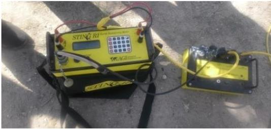
Figura 4.1.6 conmutador conectado al resistivímetro.
