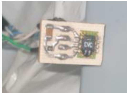
Figura 26: Placa de PCB diseñada para el sensor SHT11
