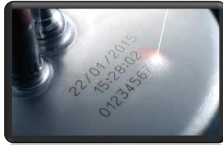
Figura 115. Marcado laser en la tapa
