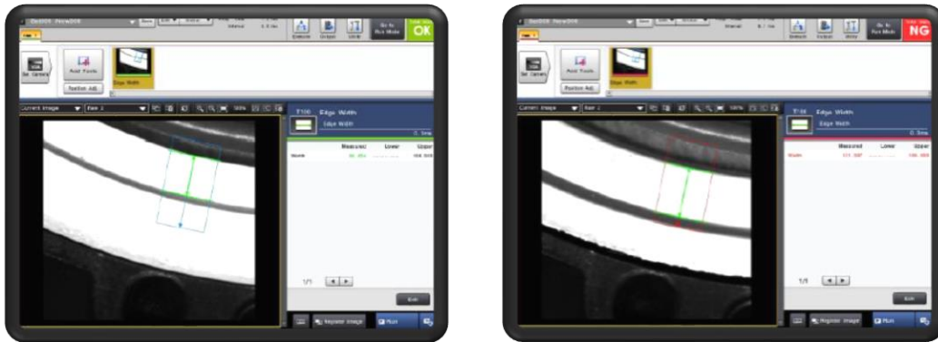
Figura 139. Parámetros de sello OK (izq.) Parámetros NO OK (drcha.)
