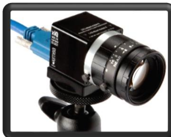
Figura 37. Cámara para sistema de visión de máquina
