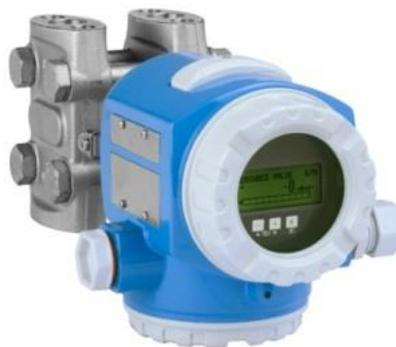
El transmisor de presión diferencial Deltabar PMD75 con sensor piezorresistivo y membrana metálica soldada se usa en todos los sectores industriales para medición en continuo de líquidos, vapores y gases. El panel de mandos de 3 teclas permite la puesta en marcha y un manejo fácil y fiable. El módulo de datos integrado HistoROM permite una gestión fácil del proceso y los parámetros de equipo. Diseñado de acuerdo con la norma IEC 61508 para uso en sistemas de seguridad SIL2/3.
