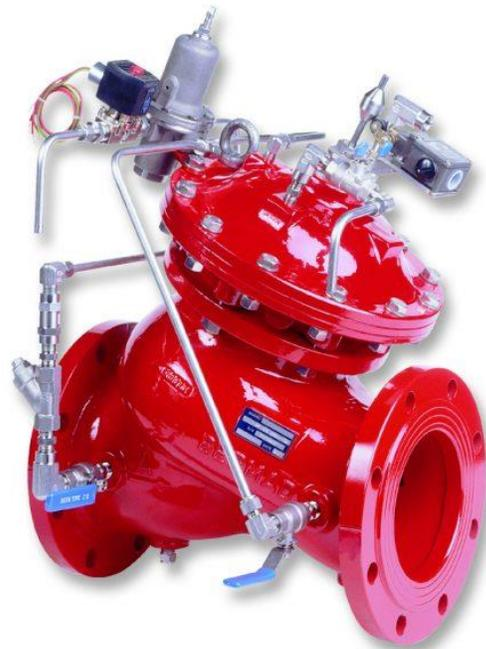
Válvula electro hidráulica operada por solenoides, controla la apertura y cierre de la válvula mecánica para el control de flujo de agua, por medio de dos solenoides se logra esta tarea, las cuales permiten el paso de presión hidráulica en una u otra dirección para el cambio de estado de la válvula, la alimentación de los solenoides es de 24 volts.
