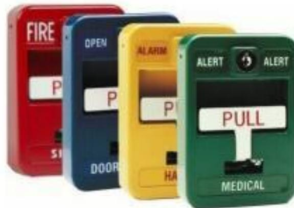
Estas estaciones manuales están diseñadas con materiales a prueba de explosión para ambientes industriales de alta peligrosidad, del tipo interruptores, funcionan al tirar de una pequeña palanca que aterriza la señal de 24 volts mandando un cambio en el estado lógico de esa señal.
