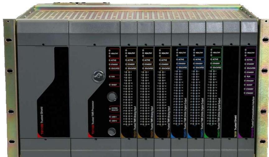
PLC TMR (Triple Modular Redundant), incorpora tolerancia a fallos, el sistema soporta una variedad de configuraciones de comunicación, incluyendo sistemas en red, OPC, Modbus y comunicación punto a punto, nivel de integridad SIL 3, para ambientes industriales, sistema triplicado y tolerante a falla evidente al usuario, cuenta con módulo de alimentación de 24 Vcd.
