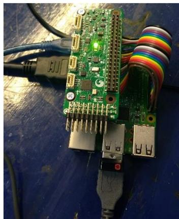
Figura 17: "Autopiloto (PXFmini y Raspberry pi 3B)"
