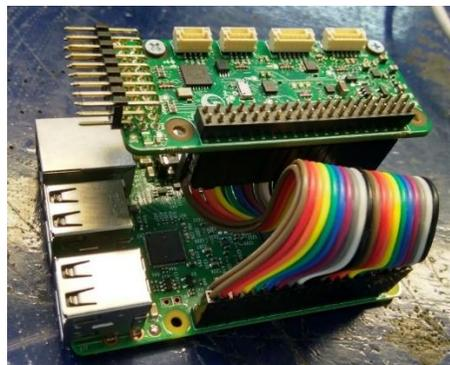
Figura 14: "Montaje de la PXFmini en la Raspberry pi 3B"
