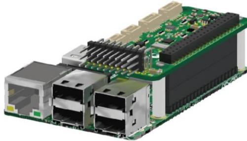
Figura 15: "Montaje ideal de la PXFmini en la Raspberry pi 3B"
