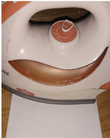
Figura 4.26: Planchado del circuito la placa fenólica.
