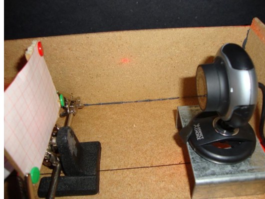
Cámara web detectando el desplazamiento
