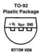
Figura 21. Empaquetado y pines del Sensor de Temperatura LM35
