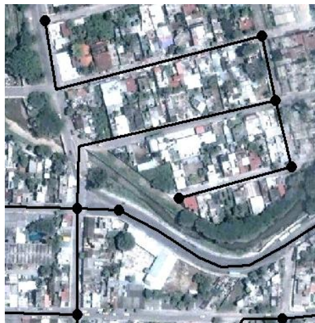
Figura 3.1 Tubería con distribución no uniforme.
