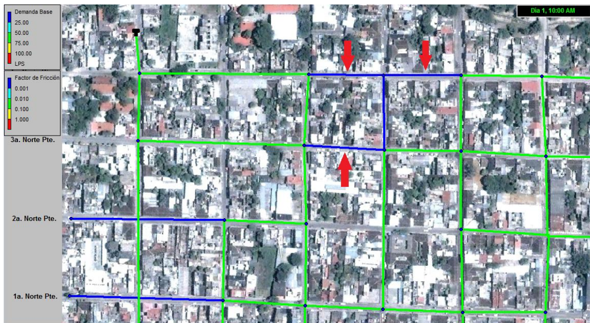
Fig 4.6 Imagen parcial mostrando la Demanda Base y el Factor de Fricción. (2ª. Sim., 10 Hrs.)
