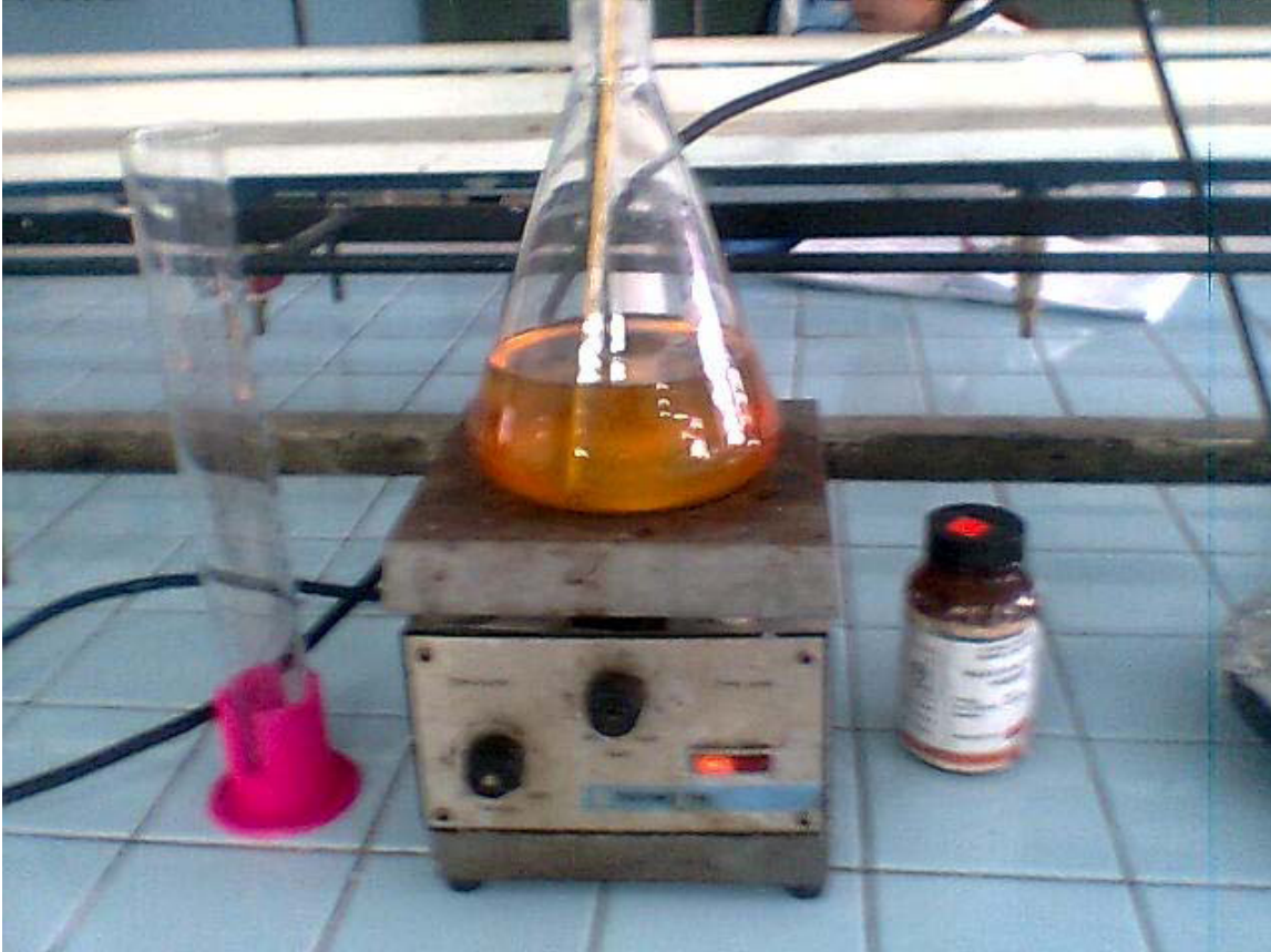
Figura 17. Transesterificación del aceite vegetal.
