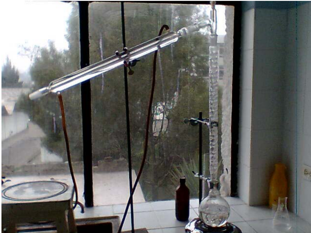
Figura 14. Equipo de destilación fraccionada. Destilación de metanol
