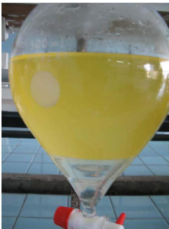
Figura 11. Biodiesel luego del tercer lavado, nótese que el agua de lavado se encuentra incolora.
