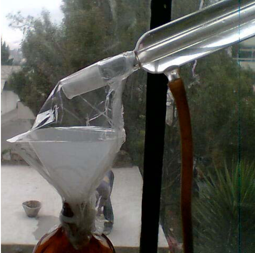
Figura 15. Agregación del metanol al biodiesel. Se colocó papel wrap para evitar la hidratación del metanol con la humedad ambiental.
