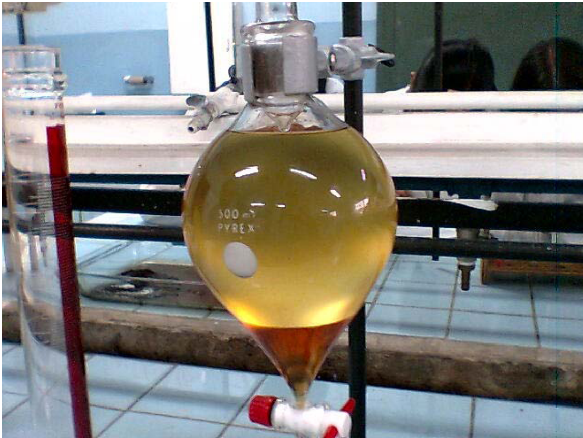
Figura 19. Separación del biodiesel de la glicerina, se puede observar el biodiesel (primera fase, arriba) y la glicerina impura (segunda fase, abajo)
