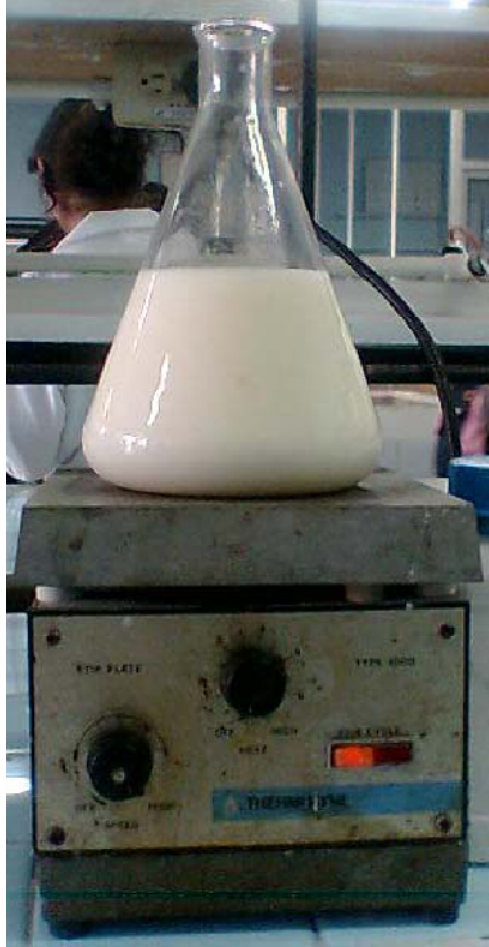
Figura 16. Preparación del metóxido de sodio.
