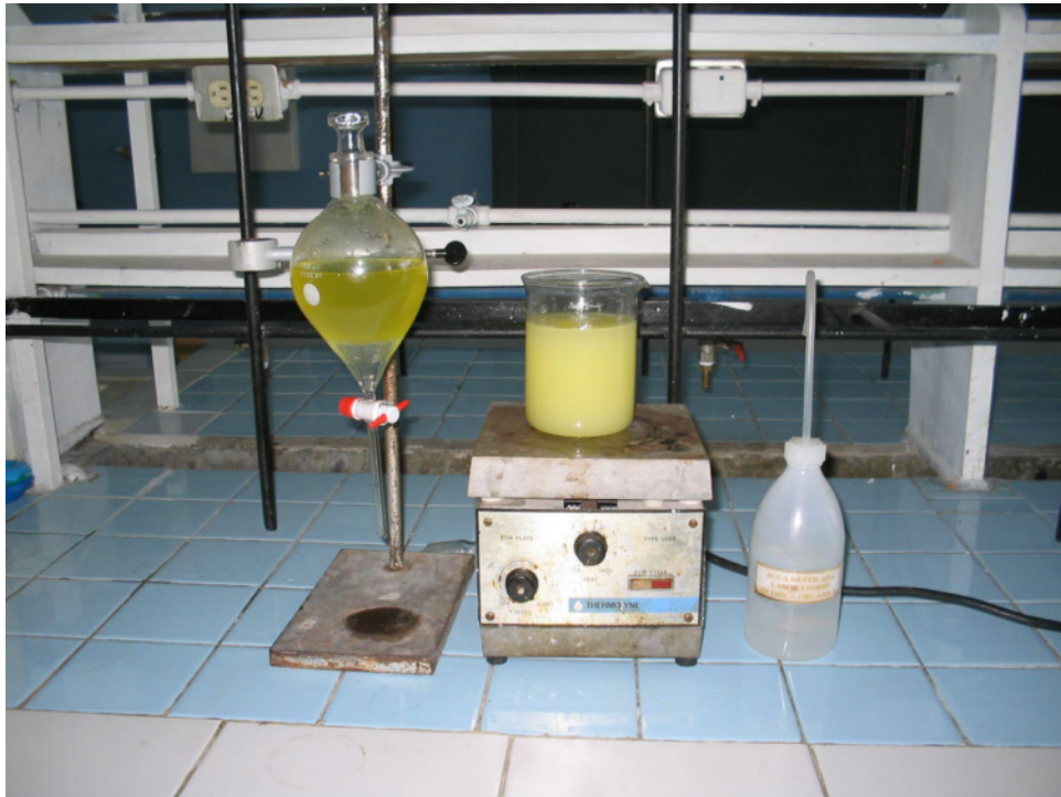
Figura 9. Lavado del biodiesel. El vaso de precipitación de la derecha es una mezcla de biodiesel impuro y agua. El embudo de separación de la izquierda es un lote de biodiesel separándose del agua.
