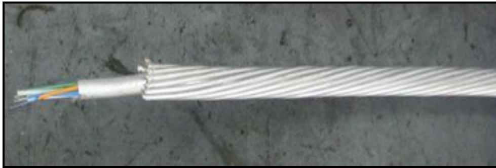
Figura 3.5 Cable OPGW utilizado en el enlace de fibra óptica.
