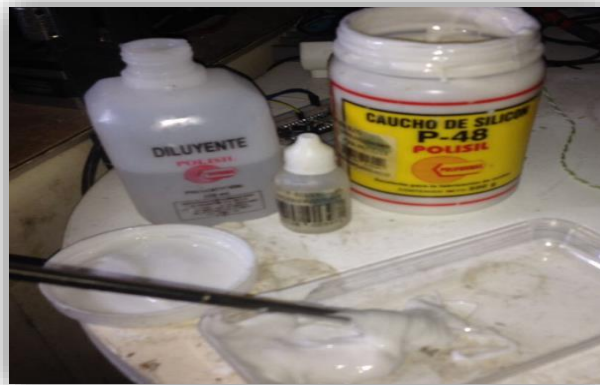
Fig. 3.24 Mezcla de Caucho de silicona P-48.
