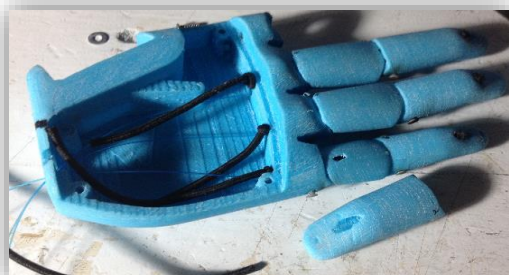
Fig. 3.19 Ensamblado de las articulaciones de los dedos y colocación de las ligas y cuerdas.
