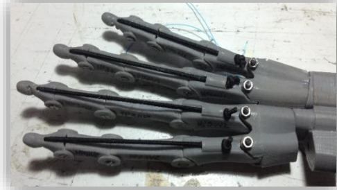
Fig. 3.3 Colocación de tiras de elástico a los dedos de la mano.
