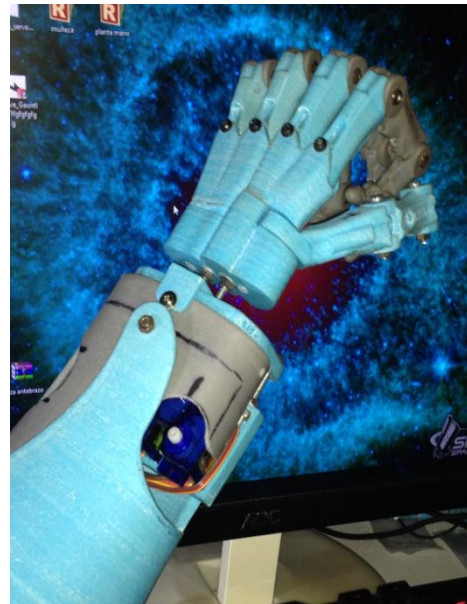
Fig. 3.6 Armado de la mano completa.
