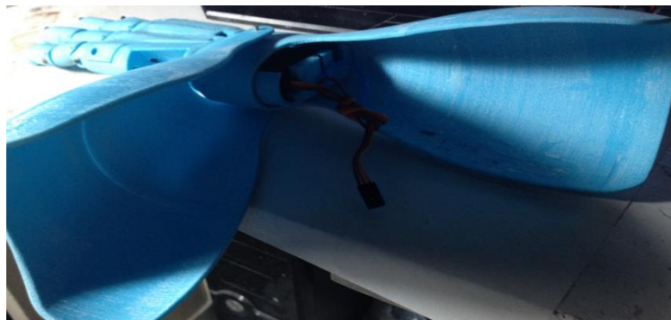
Fig. 3.23 Armado completo de la mano anexando la pieza del soporte antebrazo y tapa.
