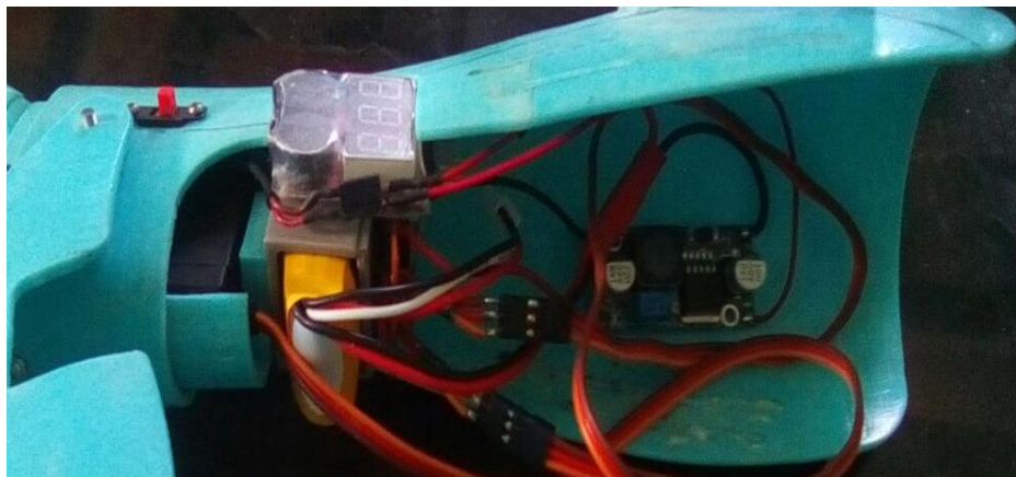
Fig. 3.31 Colocación del medidor de voltaje de pila en la parte superior del antebrazo.
