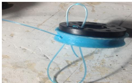
Fig. 3.21 Colocación de cuerdas al cople del servomotor.
