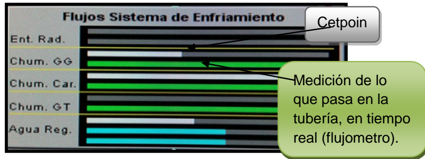
Figura 6.3 Flujos de enfriamiento
