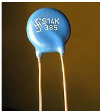
Fig. 2.8 Ejemplo de varistor
