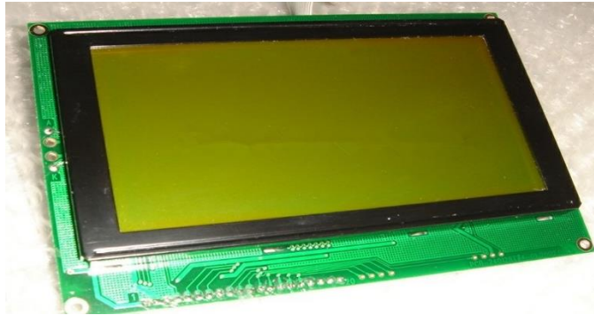
Figura 3.7: Vista frontal de la pantalla GLCD MGLS-240128TA
