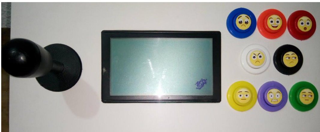
Figura 4.32: Botones modificados del tablero de control.
