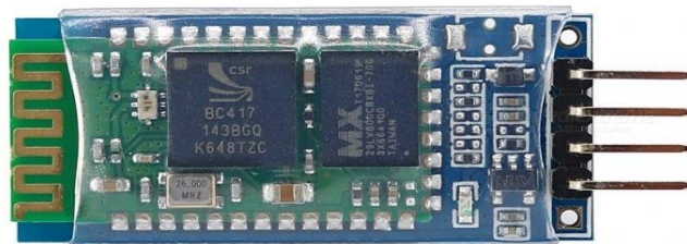
Figura 3.9: Vista superior del Módulo Bluetooth HC-06
