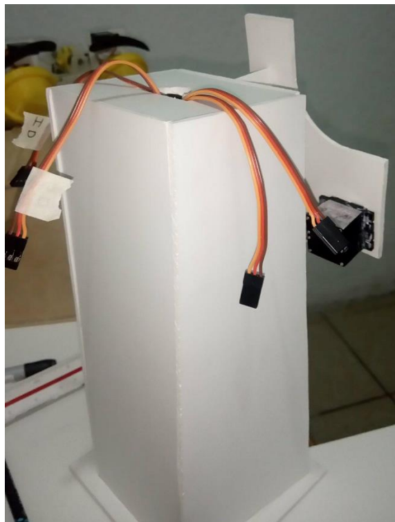
Figura 4.21: Vista posterior de la estructura para la boca y servomotores.
