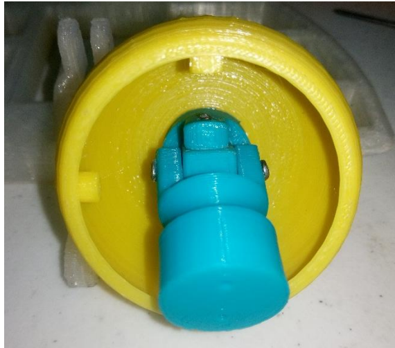
Figura 4.9: Impresión del modelado en 3D de la junta universal.
