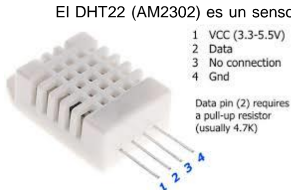
Ilustración 15. Conexión de DHT22
