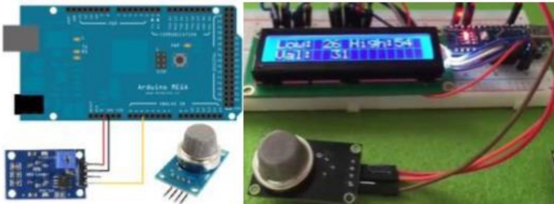
Ilustración 21. Ejemplo de conexión y funcionamiento
