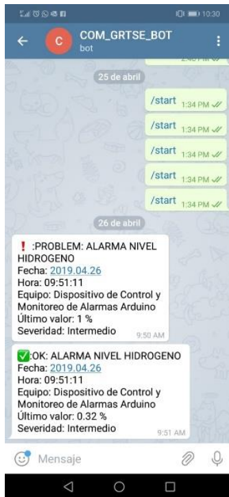
Ilustración 69. Notificación de alarma de hidrogeno
