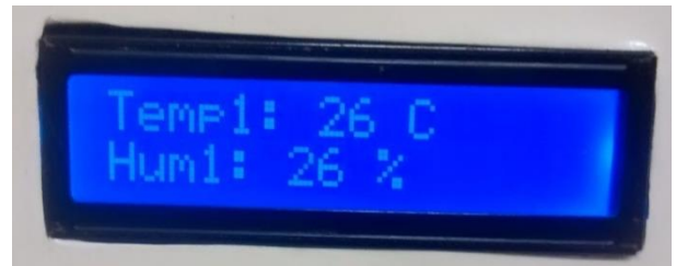
Ilustración 41. sensor DHT22 1 en operación
