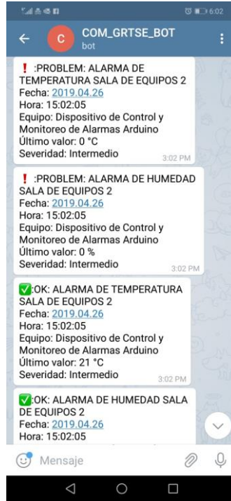
Ilustración 66. Aviso sensor de temperatura y humedad 2
